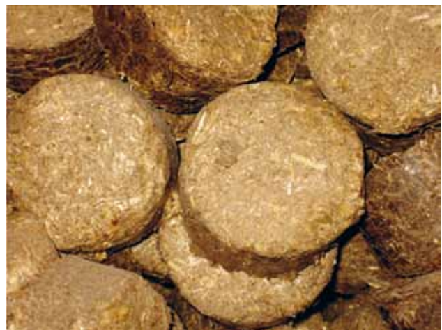
Att pressa samman rörlfen till briketter ger goda möjligheter att använda det som bränsle i mindre pannor \geq 60 kW enligt försök.
