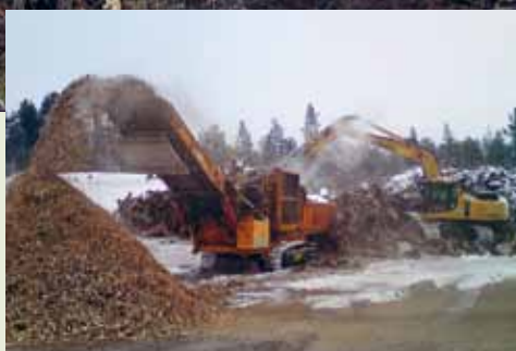
För bästa transportekonomi bör stubbar krossas så nära hygget som möjligt. Här pågår krossning vid avlägg med bandgående kross.
