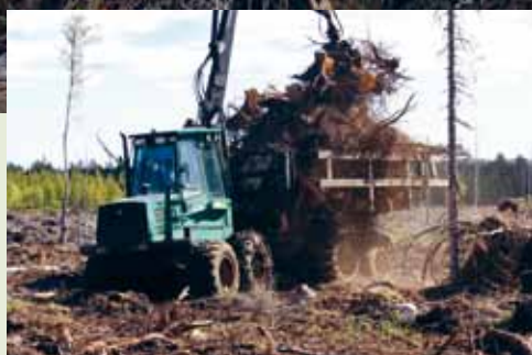
Skotning av stubbar från hygge till avlägg görs under sommarhalvåret för att föroreningar lättare ska ramla av.
