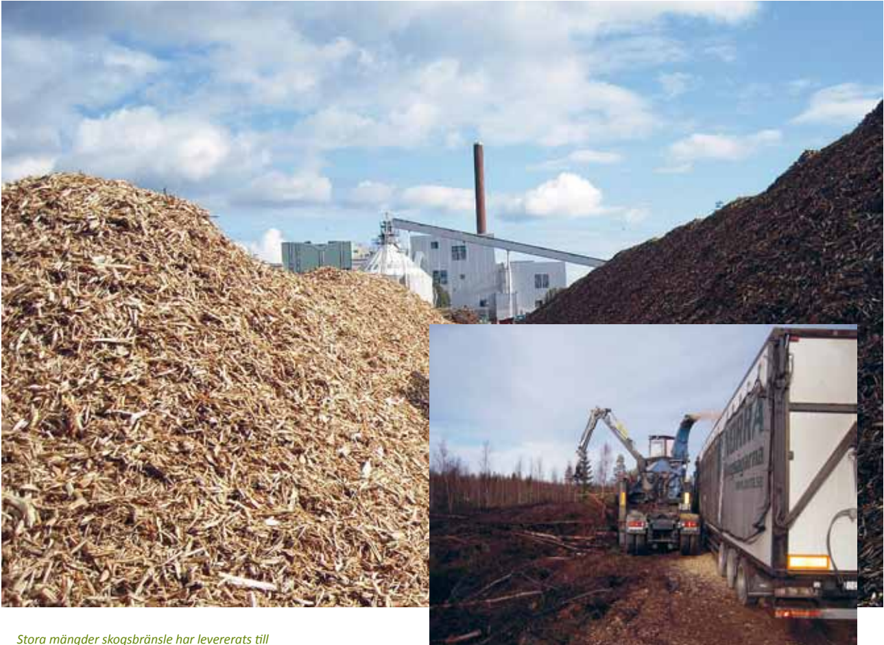
Flisning direkt i skäppa ger mindre spill och bättre torrhalt.
