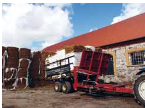
Balsamlingsvagn har visat sig effektiv för insamling av HD-balad rörlfen.
