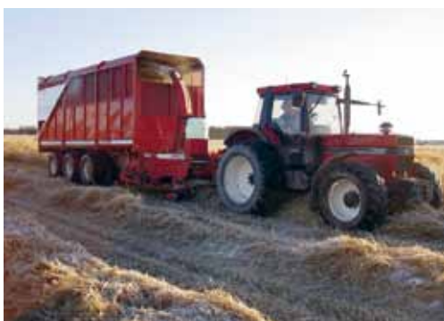
Exakthackad rörlfen med mellanlagring på gården ger bra kapacitet och passar större förbrukare där inblandning ska ske i en bränslemix.
