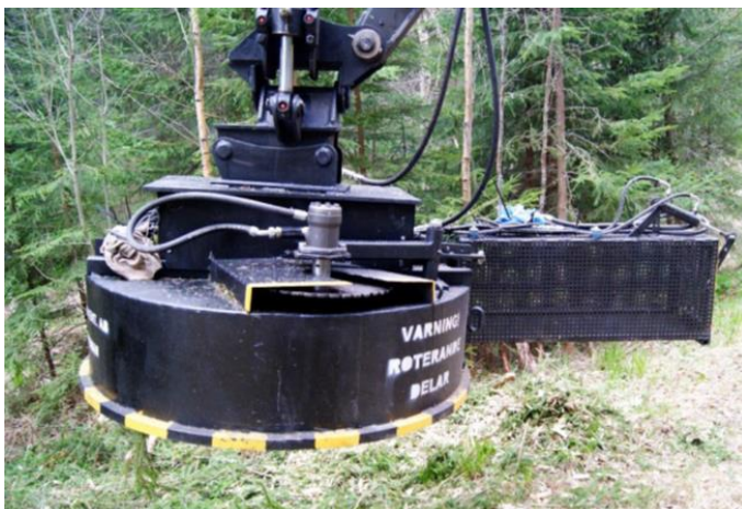
Figur 17. Aggregat för avverkning och sönderdelning av biomassa från vägkanter
