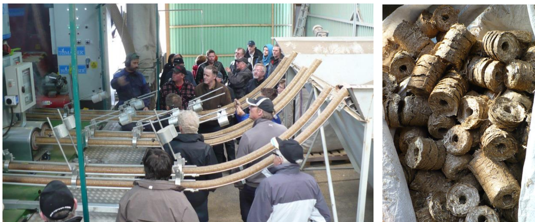
Figur 10. Rörflensbriketter från skruvpres www.glommersmiljoenergi.se/rorflenstro
