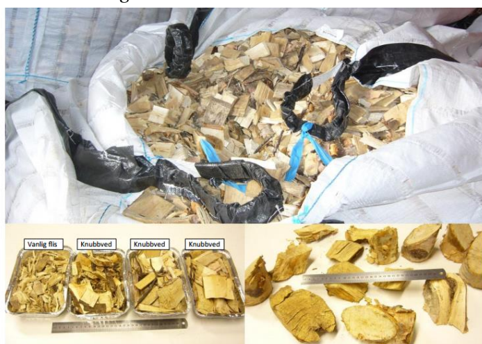
Figur 1.6. Bränslet i säckar efter torkningen, samt närbild på flis och knubbved och de större fraktioner och ändkubbar som förekommer i bränslet. Bränslet fotograferas med en stålskala som är 30 cm lång.
