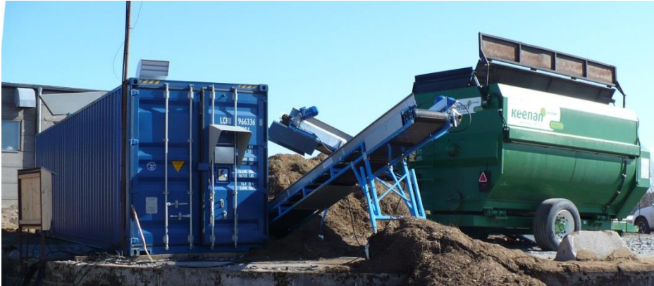
Figur 15. Torkning och hygienisering av hästgödsel i en Aerobic Fermentor www.kompostkungen.se
