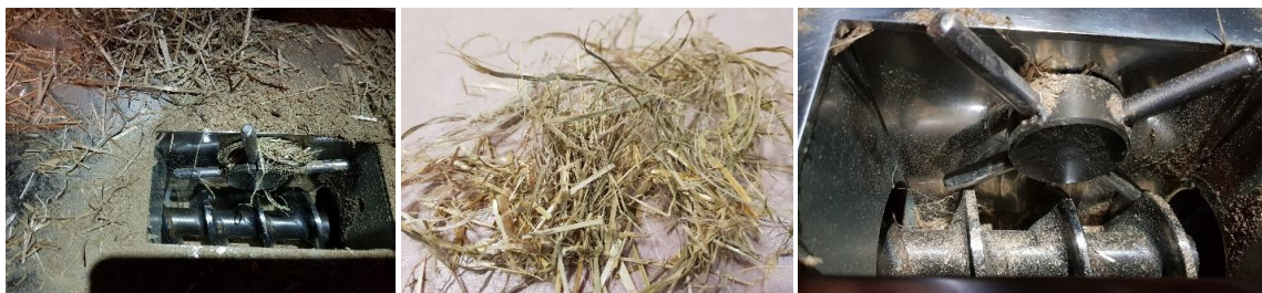
Figur 7. Rester av balnär fastnar i brikettskruven.
