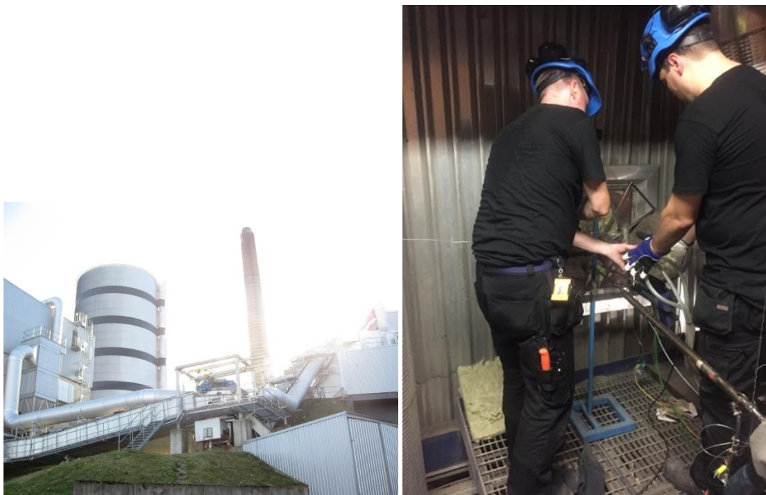
Figur 17. Mätningar av emissioner vid förbränning av en bränslemix av trädbränsle, halm och slam.
