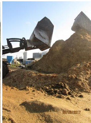
Figur 16. Avloppsslammet levererades i containerflak och tippades vid sidan av flis/halmhögen och blandades med skopa.
