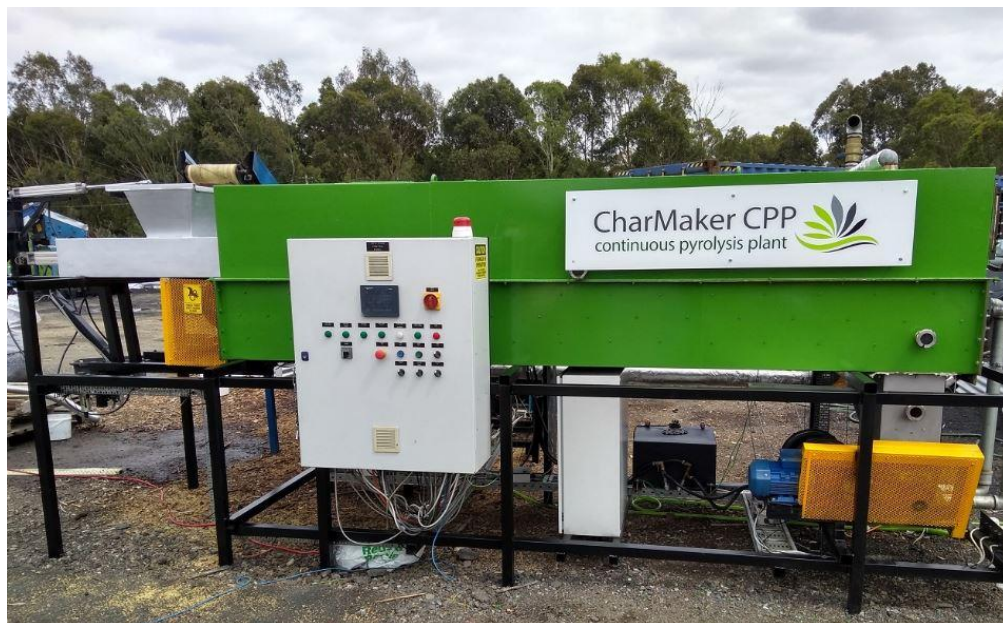
Figur 8. kontinuerligt matad pyrolyspanna, CPP Bildkälla: www.esenergy.com.au/continuous-charmaker-cpp
