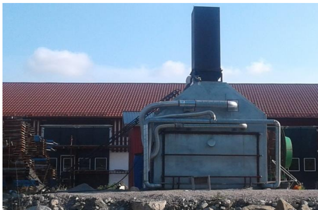
Figur 7. Batch-ugn för tillverkning av grillkol och biokol. Bildkälla: Spetsamåla gård
